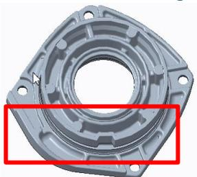
В конструкции старого фланца и кожуха отсутствуют «ВОЛНЫ»
