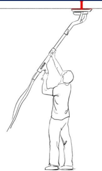
Функция присасывания при работе с потолком уменьшает нагрузку на оператора при удержании инструмента.
